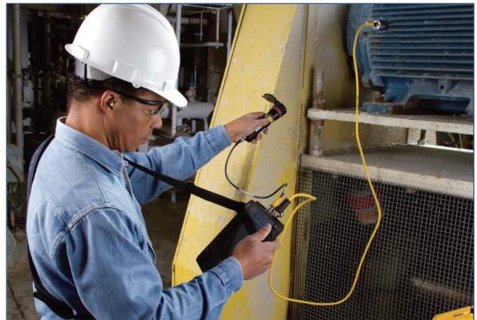
AMS 430 激光转速计在不用关停设备的情况下测定轴的转速——甚至是在空间非常狭小的位置。
