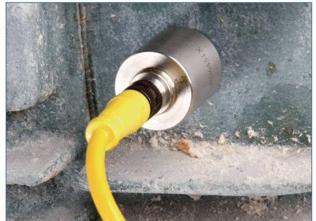
三向量加速度传感器可在测量位置同时从垂直、水平和轴向三个方向采集数据。
